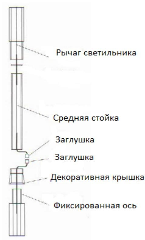
4.2 Вытащите рабочее освещение, вставьте фиксированную ось в отверстие переднего рычага светильника и закрутите его болтами M5x12.
